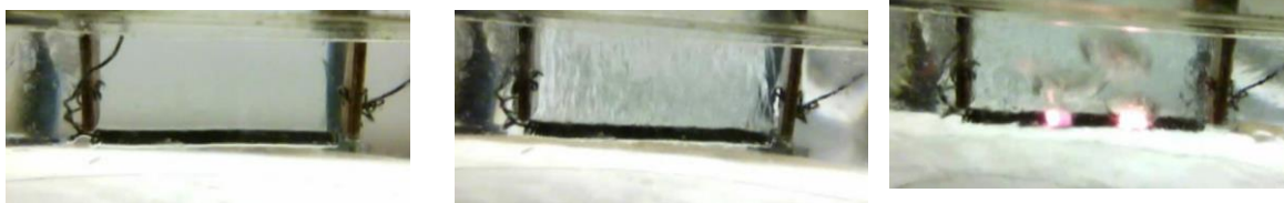
Slika 8: Blaga konvekcija (levo), jaka konvekcija i isparavanje (sredina) i nehomogeno zagrevanje (desno) [4]
